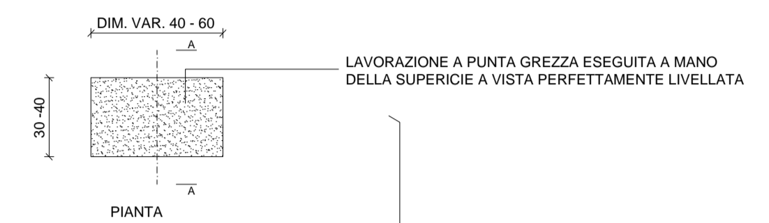
PARTICOLARE DELLE BASOLE DEI MARCIAPIEDI CON TESSITURA REGOLARE
