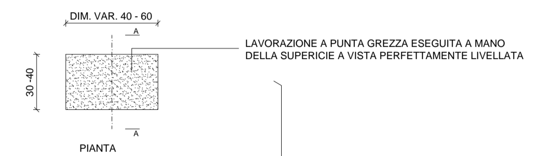
PARTICOLARE DELLE BASOLE ESISTENTI DEI MARCIAPIEDI CON TESSITURA REGOLARE
